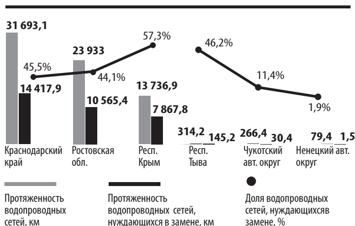
Рис. 3. Доли водопроводных сетей, нуждающихся в замене, в субъектах Российской Федерации по состоянию на начало 2018 года
