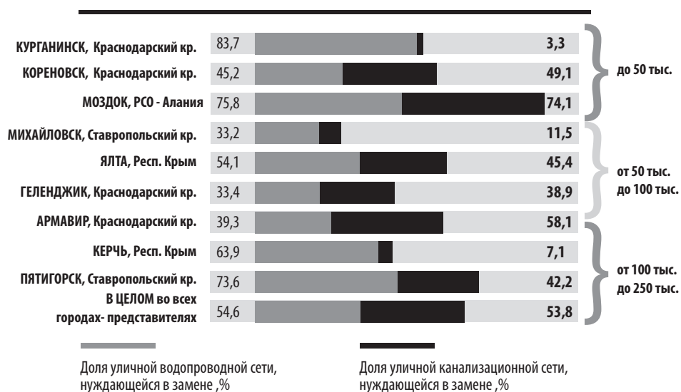
Рис. 9. Доли уличных водопроводных и канализационных сетей, нуждающихся в замене в городах-представителях IV климатического пояса, на начало 2018 года, %
