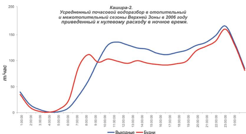
Рис. 3.9. Соотношение графиков суточных водоразборов в будние и выходные дни на конкретном здании
