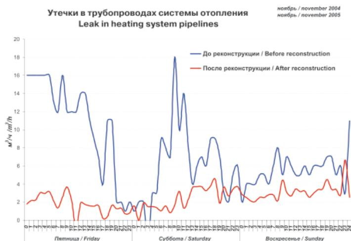
Рис. 3.1. График снижения уровня утечек в теплосети после внедрения системы SCADA на ЦТП
